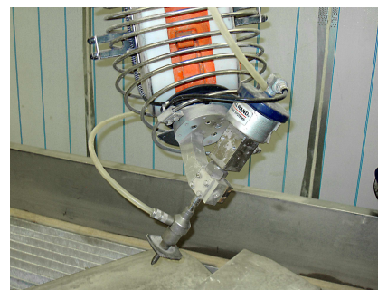
▲ Deform kan utföra tredimensionell skärning. Här utförs vattenskarning av Åkers-plåt.
